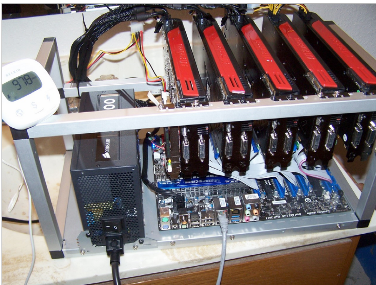
Рис. 2. Хорошая настольная ферма для брута хешей на пяти видеокартах
